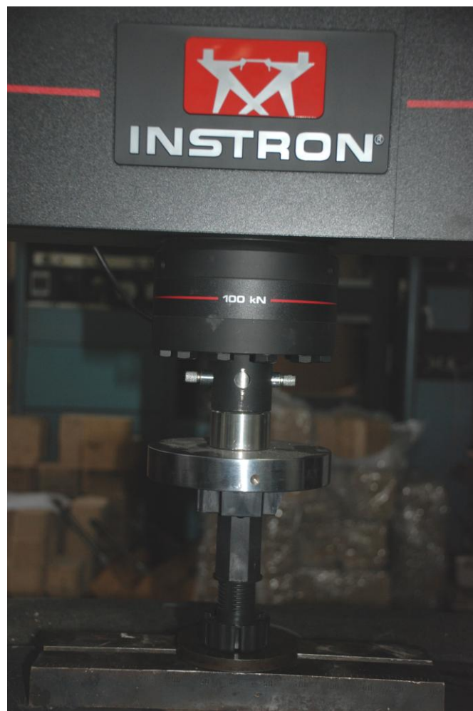
Fot. 1 Sposób badania wytrzymałości na ściskanie nóżek
